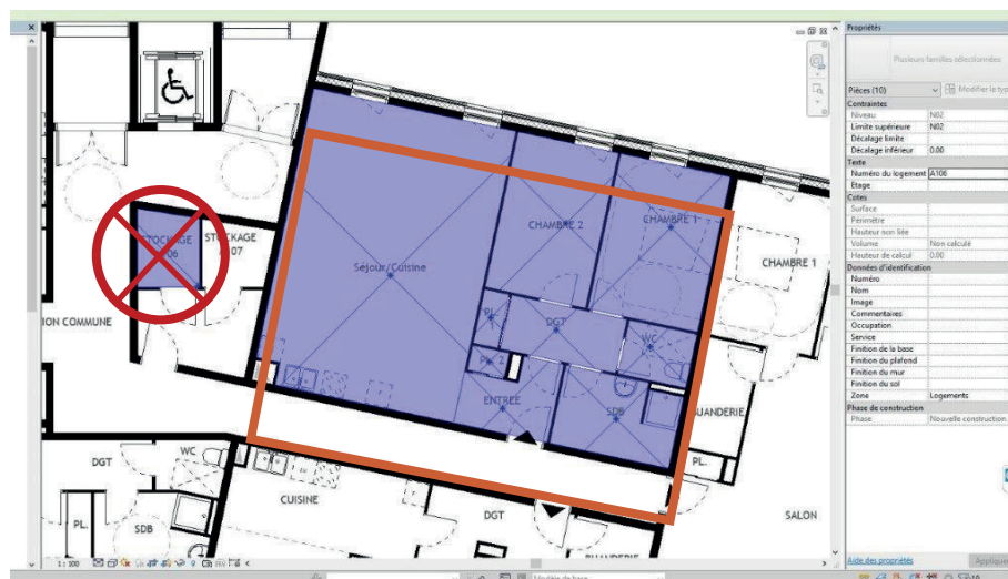
Figure 2 : A106 - Pièces non contiguës possédant le même numéro d'appartement à proscrire
